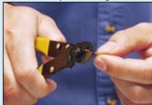
Korak 4: Ubacivanje optičkog vlakna
