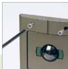
1 Uklanjanje 4 zavrtnja preko odgovarajućeg alata
